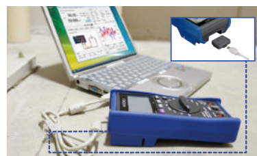
在現場將測量值儲存到PC，進行確認 使用通訊包DT4900-01(選件)
