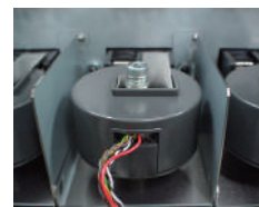
DCCT電流感測器 (PW3337內部)
