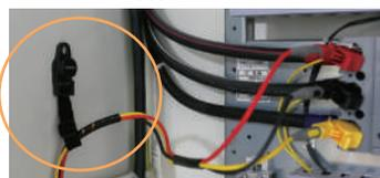
如果由於電壓線的重量而使夾子很容易從端子上掉下來時，可以使用吊帶 Z5004 來輔助電壓線。
