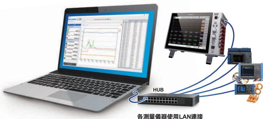
各測量儀器使用LAN連接
