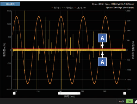
部分放電檢測的閾值設定
