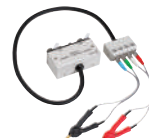
4端子探棒L2000 最適合用於螺絲端子夾子・連接線長1m・ BT4560連接時無法使用3mΩ量程・ 無組合精度規定
