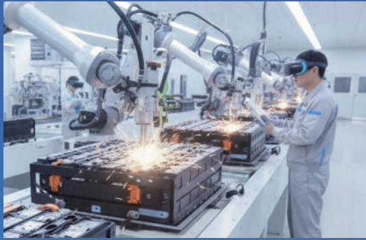
適用於電池匯流排的焊接檢查
