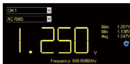
DVM量測視窗監控 1KHz · 2.5Vpp 的方波
