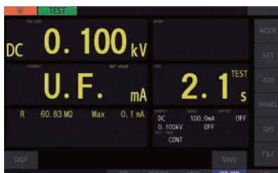
透過自動量程功能將測量量程自動化
