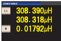
變壓器測量模式 相互電感測量畫面
